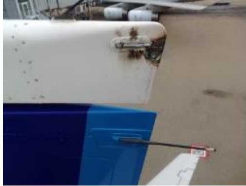
Fig. 1.2-2 翼端部への被雷
