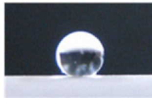
Fig. 4.1-6 防除氷コーティング（超撥水性）面上の水滴の様子 4.1.21)
