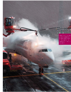
Fig. 4.1-3 使用される防除氷液（左）と地上での防除氷作業（右） 4.1.6), 4.1.7)
