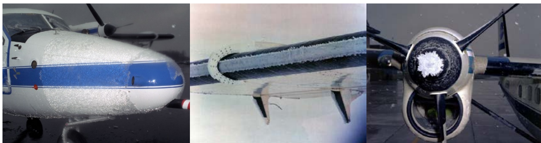
Fig. 4.1-2 機首（左）翼（中）スピナー（右）への着氷（右） 4.1.3)-4.1.5)
